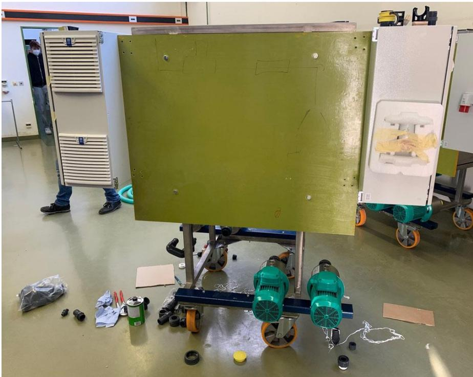
Zwischenstand der Arbeiten: Versuchsaufbau mit Speicherbehälter und Pumpenelementen, Schaltschrank
